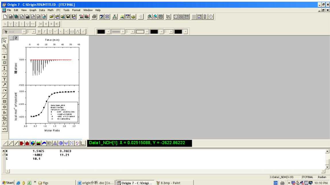
14. 复制含有 N、K、 $\Delta H$ 、 $\Delta S$  数值的方框，点击工具栏“ITC”中“Final Figure”，在得到的图片中粘贴上述方框；
