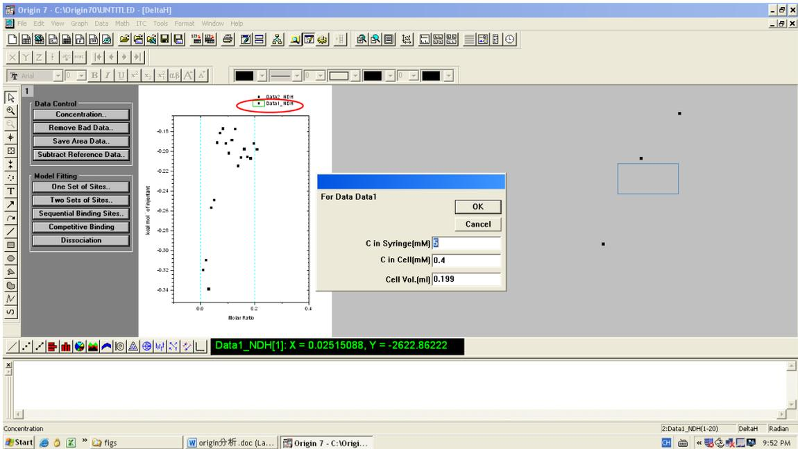
9. 单击“Data1\_NDH”左侧黑色小方块，再点击“Concentration”，在弹出的窗口中会显示“C in Syringe”（Syringe 中样品的浓度），“C in cell”（样品池中的浓度），“Cell Vol”（样品池体积，不要更改这个数值！），记录 Syringe 和样品池中样品的浓度，点击“OK”；
