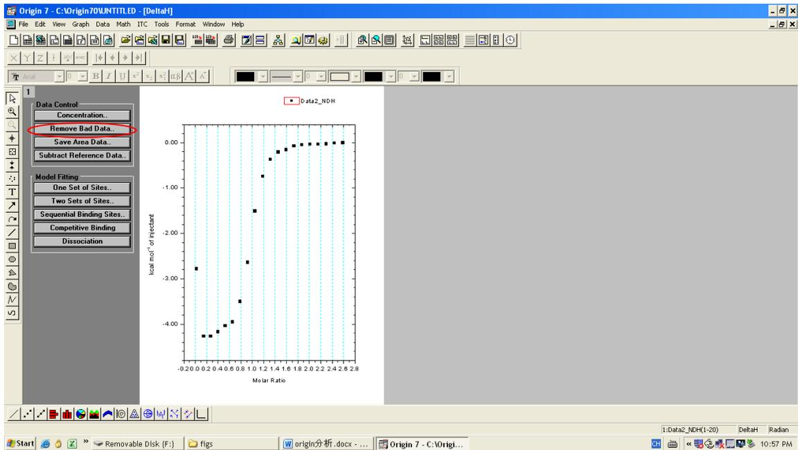
2. 点击“Remove Bad Data”，光标变为方框，将光标移动至需要删除的点处，单击选中该点，再按“Enter”键即可消除 bad data，结果如下图所示；
