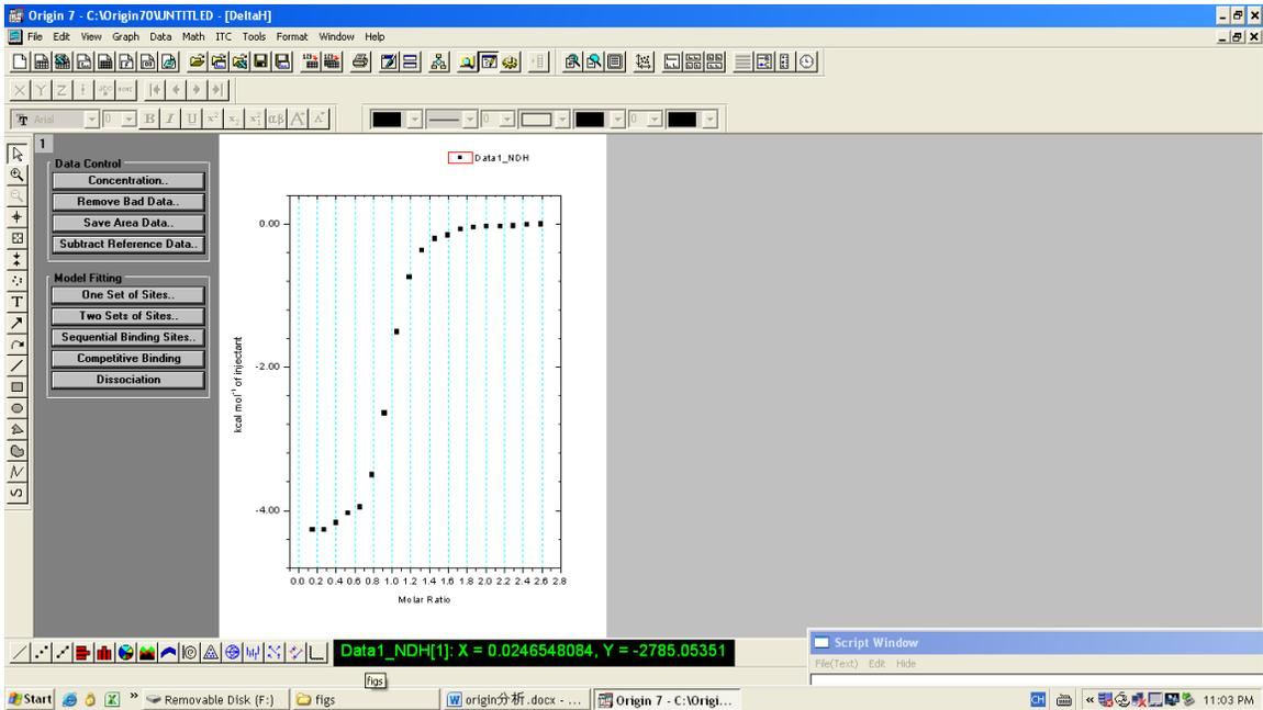
3. 如希望利用点对点扣除背景，请转至步骤 7；如希望用最后几个点进行背景扣除，请按照以下步骤操作；
