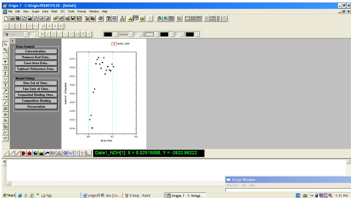
7. 如希望利用点对点扣除背景，请按照以下操作步骤进行。在工具栏“Window”中选择“mRawITC”，点击“Read data”，在相应文件夹中找到对照实验的结果文件，导入软件，此时软件中只会显示第二次导入的数据；
