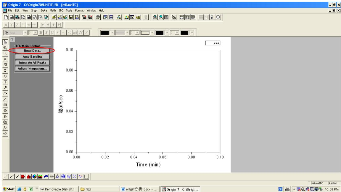
1. 打开 Origin 软件（MicroCal, LLC ITC200），点击“Read data”，在相应文件夹中找到 iTC 实验结果文件，导入软件，如下图所示；
