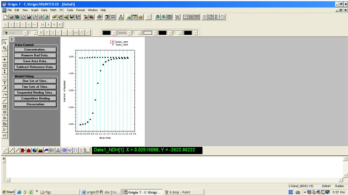
10. 单击“Data2\_NDH”左侧黑色小方块，再点击“Concentration”，在弹出的窗口中将“C in Syringe”和“C in cell”分别改成与“Data1\_NDH”相同的 Syringe 和样品池浓度，“Cell Vol”不要更改，点击“OK”；
