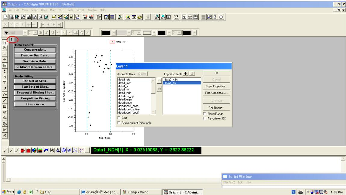
8. 双击左上角数字 1 的灰色方框，出现窗口“Layer1”；选中“data1\_NDH”再点击符号“=>”将 data1 的数据导入右侧区域（此时方框内共有 data2\_NDH 和 data1\_NDH 两组值），点击“OK”，此时“Data1\_NDH”、“Data2\_NDH”都会显示在窗口中；
