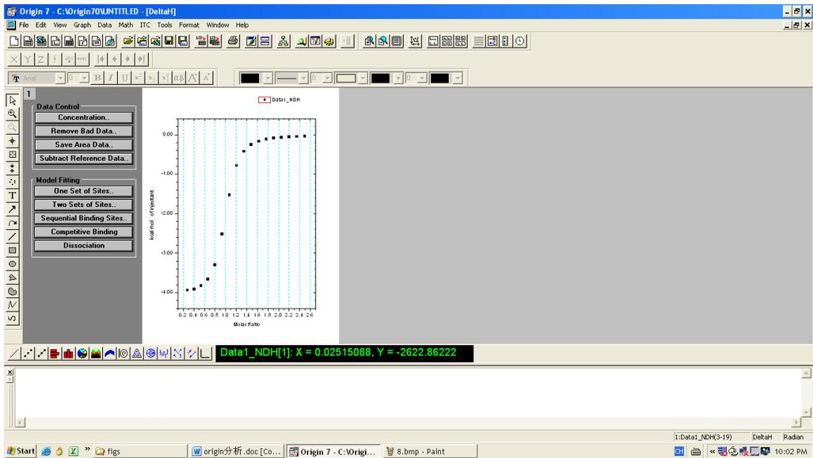
11. 点击“Subtract Reference Data”，在弹出的窗口中将“Data”选为“Data1\_NDH”，Reference 选为“Data2\_NDH”（Data1 和 Data2 分别为测试样品数据和对照组数据），点击“OK”，软件会完成扣除背景操作；
