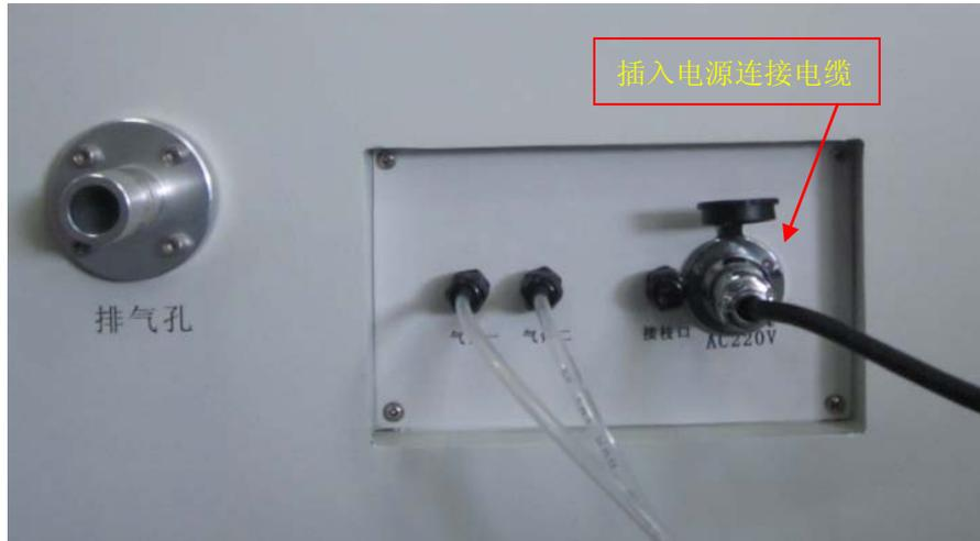
4. 将气管卸下，气管另一头连接到相应钢瓶减压阀上的接头上，并用卡箍拧紧确保密封，如下图所示：
