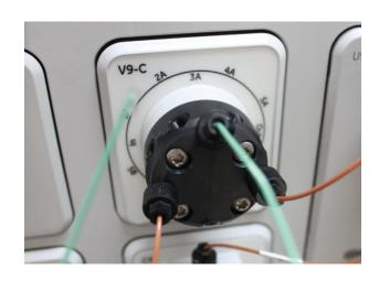
5) 除去层析柱下堵头,并将层析柱出口连接到柱位阀的相应位置上,然后拧紧上接头
