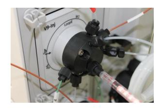
2) 用注射器吸取稍大于样品环体积的样品,将注射器内的样品从 Syr 口 推入,注意不要将气泡推入样品环
