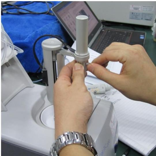
7. 根据软件提示将连接头旋出
