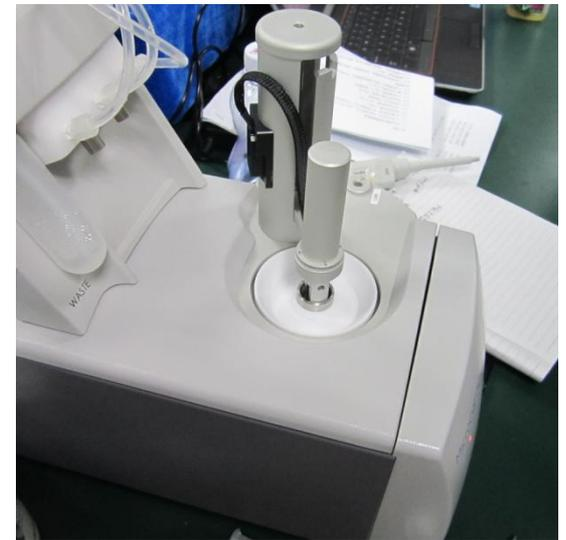
9. 根据软件提示将pipette插入样品池中，点击OK
