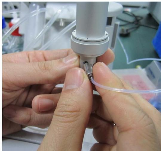
4. 左手固定住注射器上端，使注射器的连接孔对准支架上的孔。右手将白色细管顶部的接头水平对准注射器连接孔，先轻轻将接头前端乳白色部分插入连接孔，随后将金属接头轻轻拧紧即可，感觉到拧不动即可（切勿用力拧死，会造成玻璃注射器破碎）。
