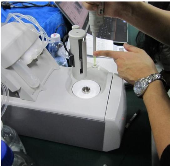
1. 将装有约 60-100  $\mu\text{l}$  样品的试管放入样品试管槽，将试管盖子卡在右侧的缺口位置
