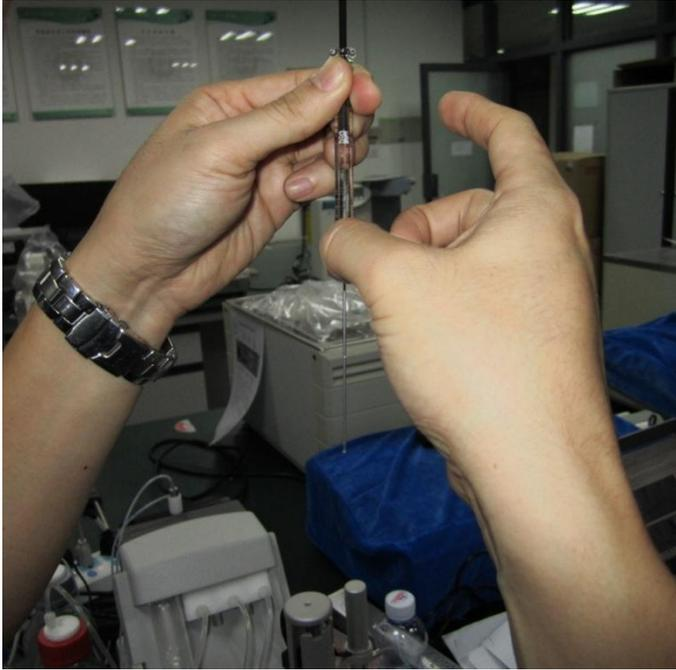
1. 用玻璃注射器吸取约350 $\mu$ l样品，轻弹注射器壁赶出气泡；
